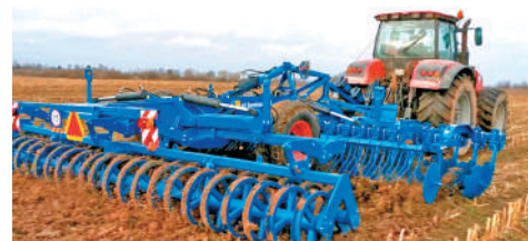
Агрегат дисковый почвообрабатывающий АД-600 М «Рубин» (укомплектован двойным прикатывающим катком с кольцами U-образного профиля)
